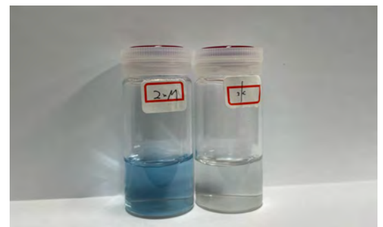
Figure 4. 2.0 mM の炭酸水素ナトリウムを溶かした500 mM の塩化ナトリウム水溶液(左)と 500 mM 炭酸水素ナトリウム水溶液(右)に対する錯体2の呈色結果
