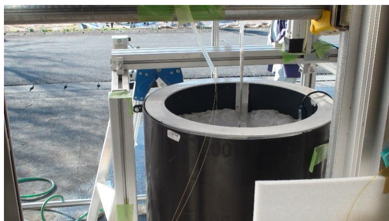
図10 開発した光ファイバースローブによるオゾニドフォーム計測（現場実験）
